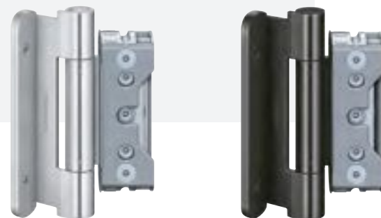
Objektbänder BAKA Protect 4010 3D FD, 3D-verstellbar, mit Flügelichtung, CE-zertifiziert, Belastungswert 160 kg, Rollenlänge 140 mm, Rollendurchmesser 20 mm
