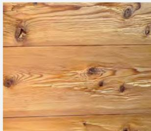
Lärche Antik Blockwand gedämpft, gehackt und leicht gebürstet
