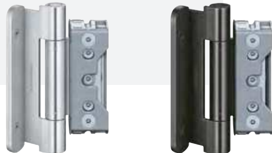
Objektbänder BAKA Protect 4010 3D FD, 3D-verstellbar, mit Flügeldichtung, CE-zertifiziert, Belastungswert 160 kg, Rollenlänge 140 mm, Rollendurchmesser 20 mm
