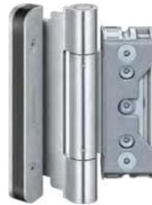
BAKA Protect 4010 3D FD in Topzink oder in Edelstahl, 3D-verstellbar, mit Flügeldichtung, CE-zertifiziert, Belastungswert 160 kg, Rollenlänge 140 mm, Rollendurchmesser 20 mm
