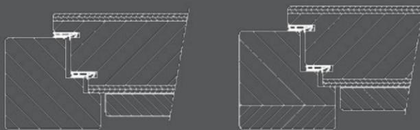
+ mit Türblatt-Aufdoppelung für Stock und/oder Flügel bei Altholz-Oberflächen
