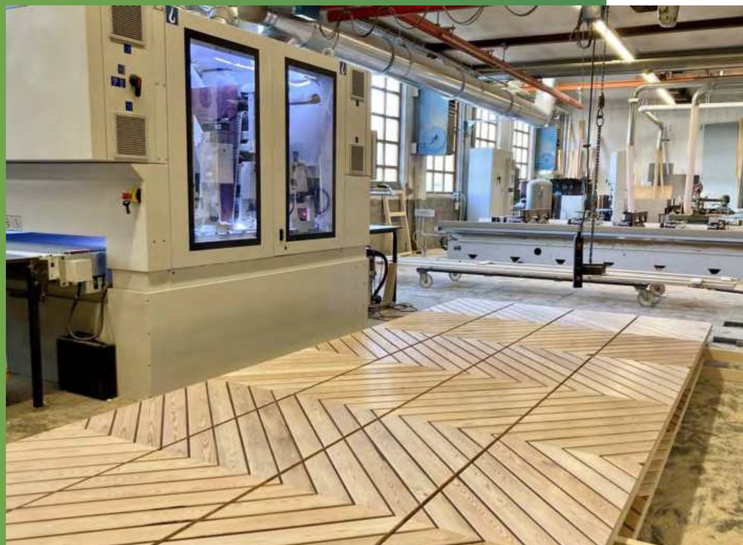
ALLEMANN® Produktion: Breitbandschleifmaschine und 5-achsiges CNC-Bearbeitungszentrum inkl. 3D-Programmierung
