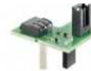
Conex ● zum Anschluss eines externen, kabelgebundenen Tasters
