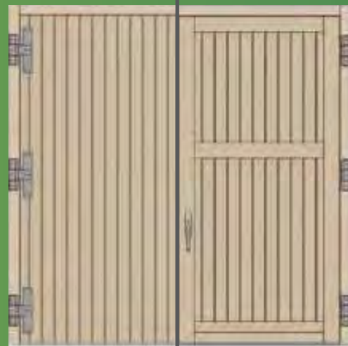
Links: Aufgeschraubte Konstruktionsbänder bei Toren ohne Friesen Rechts: Aufgeschraubte Konstruktionsbänder bei Toren mit Friesen (Bänder weitgehend verdeckt)
