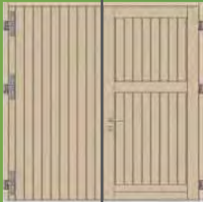
Links: Aufgeschraubte Torbänder bei Toren ohne Friesen Rechts: Aufgeschraubte Torbänder bei Toren mit Friesen (Bänder weitgehend verdeckt)
